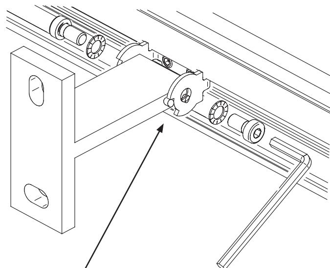
Anschlag-Pin entgegen Kabelseite, Querloch unten
