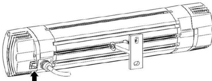
Het verwarmingsvermogen wordt geschakeld door de schakelaar of de afstandsbediening te bedienen.
