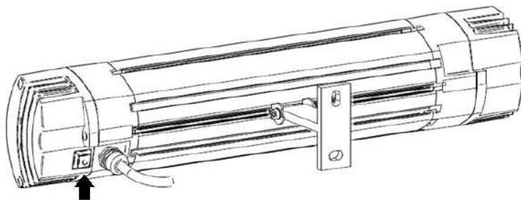
Die Heizleistung wird durch die Betätigung des Gerätetasters oder der Fernbedienung geschaltet.
