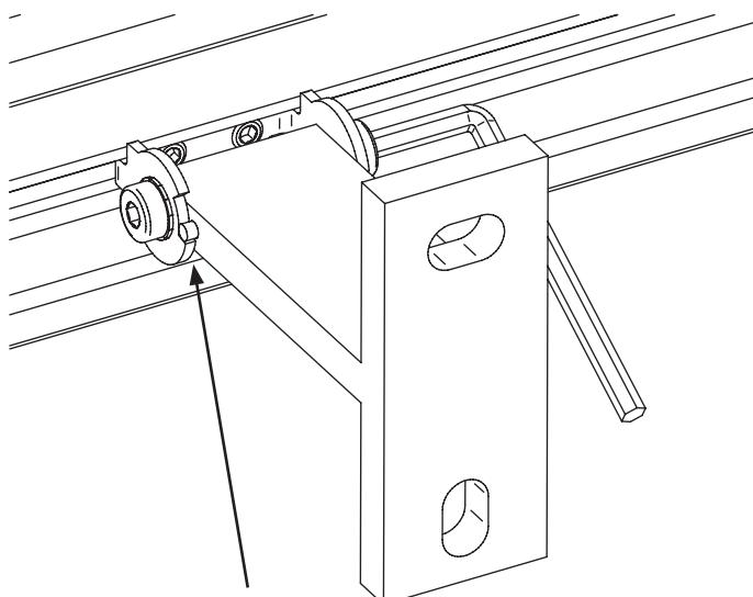
Anschlag-Pin an der Kabelseite, Querloch vorne
