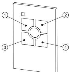
**AANWIJZING:** Het apparaat is uitgerust met een elektronische veiligheidsuitschakeling bij een abnormale gebruikspositie. Het apparaat is bij levering al ingesteld op de bedrijfsstand (wandmontage 45° gekanteld) en zonder tijduitschakeling geprogrammeerd.
